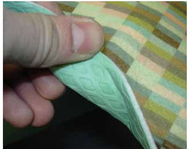
Particolare ingrandito della gomma antiscivolo posta sotto la passatoia
